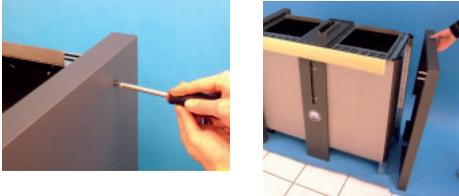
Nach dem Ausrichten des Saunaheizgerätes die eventuell noch vorhandene Schutzfolie abziehen und die Seitenteile wieder anschrauben.
