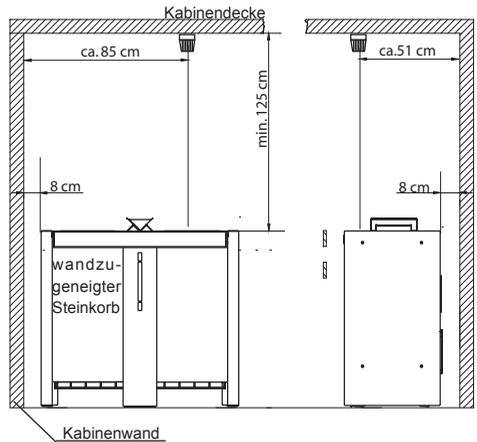
Entgegen den Angaben zu Fühlermontage Ihres Saunasteuergerätes, wird der Ofenfühler nicht mittig über dem Saunaheizgerät, sondern wie in der Abbildung gezeigt über dem, der Kabinenseitenwand abgeneigten Steinkorb montiert.
