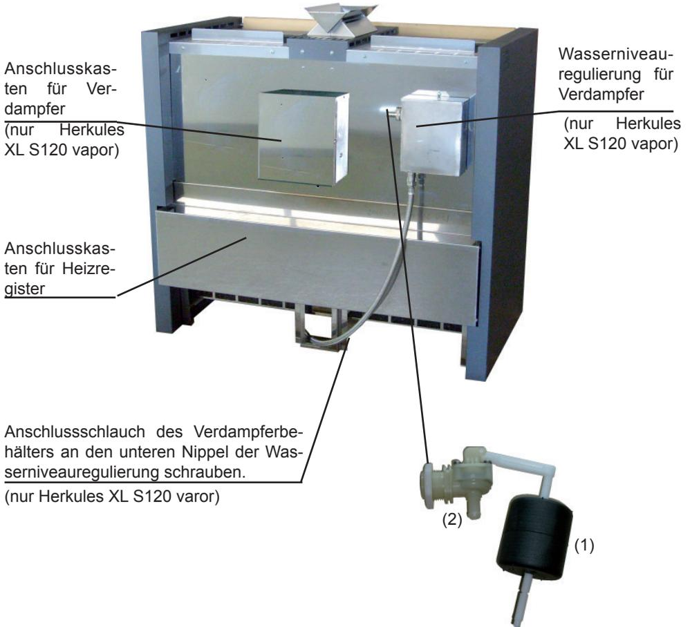
Das Schwimmerventil (1) öffnet oder schließt das Ventil (2), so dass immer ein voller Behälter gewährleistet ist.
