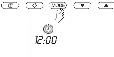
Сейчас с помощью кнопок ▼ и ▲ Вы можете выбрать продолжительность нагрева. Однако помните, чтобы получить надлежащий климат в кабине, она должна прогреваться 40-50 минут. Если Вы, к примеру, хотите приступить к приему сауны в 18:00, то на таймере следует устанавливать время 17:10..
