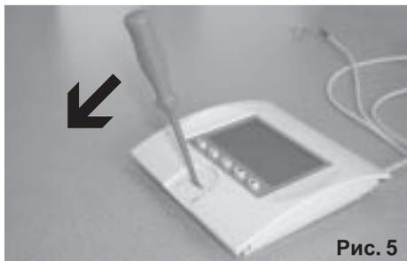
2. Деблокируйте корпус, слегка вращая или наклоняя отвертку в направлении стрелки (Рис. 5) и откиньте верхнюю часть корпуса вверх.
