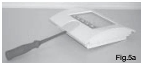
Puis il faut que la partie supérieure du boîtier soit détachée de l'arrière de la prise de fixation (voir fig.6).
