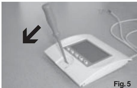
2. Déverrouillez le boîtier en tournant ou en bougeant légèrement le tourne-vis dans la direction de la flèche (fig.5) et poussez vers le haut la partie supérieure du boîtier.
