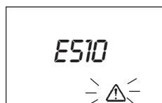
Si dans les deux minutes allouées, le remplissage en eau n'a pas eu lieu, l'appareil, pour des sécurité, met hors d'état de fonctionnement tout le système de sauna. Et sur l'affichage apparaît le message d'erreurs suivant.
