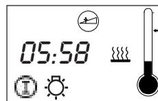
Befindet sich das Gerät im Feuchtebetrieb (Ebene "P3 = 0") sind jetzt Saunaofen, Kabinenbeleuchtung und Verdampfer in Betrieb.
