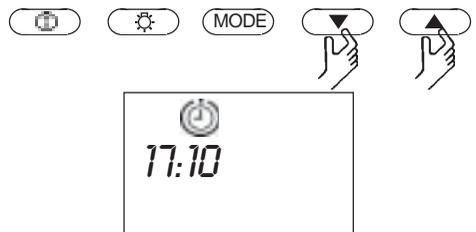
Übernehmen Sie den neuen Wert durch Drücken der **"Mode"** -Taste bis das Vorwahlzeit-Symbol blinkt und die Steuerung schaltet zurück zur Ruheanzeige.
