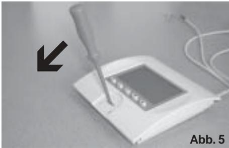
2. Entriegeln Sie das Gehäuse durch leichtes Drehen oder Kippen des Schraubendrehers in Pfeilrichtung (Abb.5) und schwenken Sie das Gehäuseoberteil nach oben.
