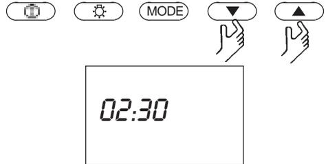
Nach dem bestätigen der Eingabe, durch Drücken der "**Mode**" - Taste bis der neue Wert blinkt, geht das Gerät in den Ruhezustand zurück. Der neue Wert wurde damit übernommen.
