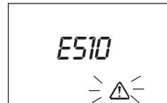
Wird innerhalb der eingestellten Zeit kein Wasser nachgefüllt, schaltet das Gerät aus Sicherheitsgründen die gesamte Saunaanlage ab. In der Anzeige sehen Sie nebenstehende Fehlermeldung.
