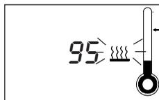
С помощью кнопок "▼" и "▲" вы можете устанавливать желаемые показатели. Стрелка на символе термометра указывает на предварительно выбранную температуру.
