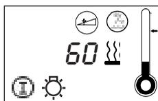
По истечении времени нагрева установка автоматически переключается в режим программы последующего нагрева с целью выполнения досушивания кабины. При этом выключается символ режима влажной бани и начинает мигать символ рабочего режима "I".
