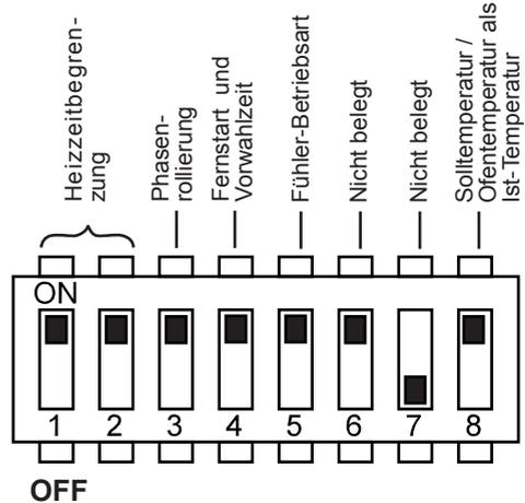
Abb.5 Funktionswahlschalter - Standardeinstellung
