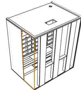
Glastüre an schmaler Aussenseite mit Scharnieren befestigen und einstellen. Technik je nach Ausstattung komplettieren.
