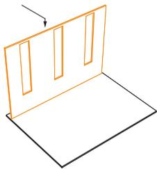
Bodenplatte auf geraden Boden legen (mit Wasserwaage prüfen!) und Schrauben und Beschläge zurechtlegen. Unterteil der Rückwandplatte in Boden einstecken und befestigen
