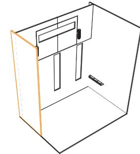
Schmale Seitenwand mit Boden und Rückwand verbinden.
