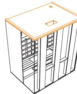
Deckenplatte auflegen und von oben festschrauben.
