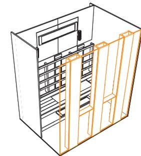
Vordere Wand (Gläser und Säule) abwechselnd in vorbereitete Bohrungen und Nuten einsetzen.
