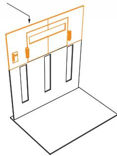
Rückwand der Kabine an der vorgegebenen Einkerbung fixieren und festschrauben.
