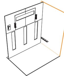
Breite Seitenwand mit Boden und Rückwand verbinden.
