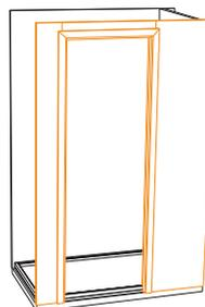
**Montage bei Schiebetür:** Vorderwand an der vorgegebenen Position festschrauben.
