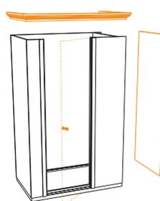
Deckenplatte auflegen und von oben festschrauben. Türe und Verblendung der Seitenwand montieren.
