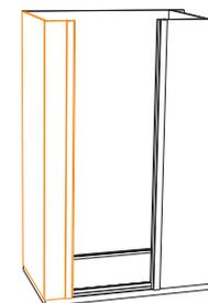
**Montage bei Angeltür:** Seitenwand mit Vorderteil (1 Teil) an der vorgegebenen Position festschrauben.
