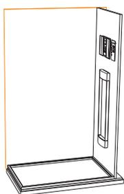
Rückwand der Kabine an der vorgegebenen Position fixieren und festschrauben.
