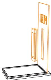
Bodenplatte auf geraden Boden legen (mit Wasserwaage prüfen!) und Schrauben zurechtlegen. Seitenwand in die Bodenplatte stecken und befestigen. Strahler nach Montageanleitung montieren.
