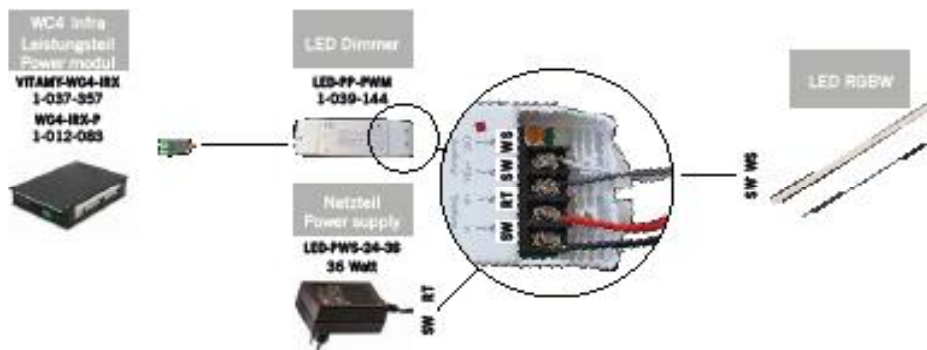
Fig. 44: Conexão da tira LED ao comando
