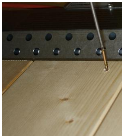
Fig. 38: Montaggio della mascherina degli irradiator posteriori
