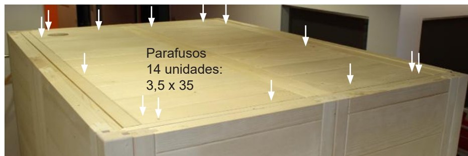
Fig. 19: Fixação dos elementos de teto
