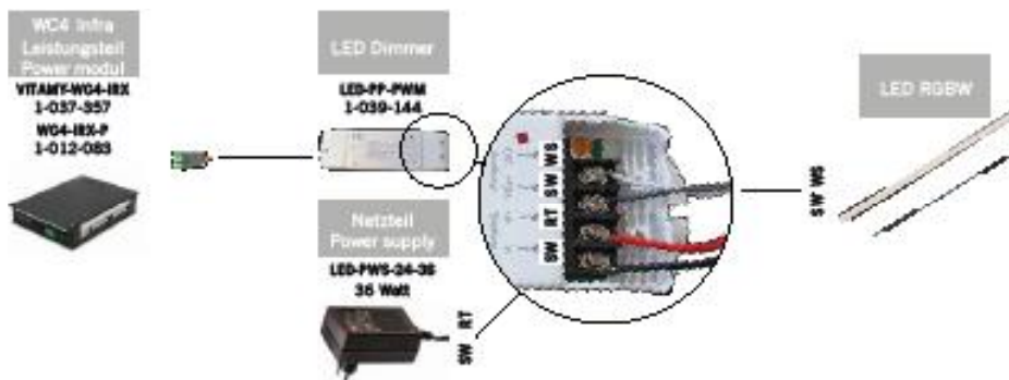
Abb. 43: Verbinden des LED RGBW mit der Steuerung
