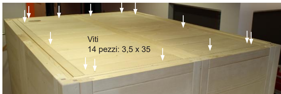
Fig. 19: Fissaggio degli elementi tetto
