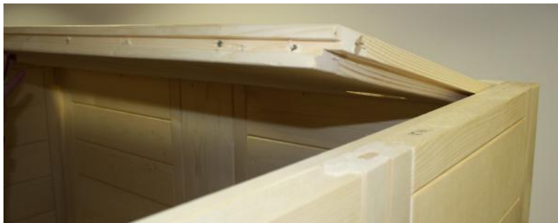
Fig. 18: Inserimento dell'elemento tetto anteriore
